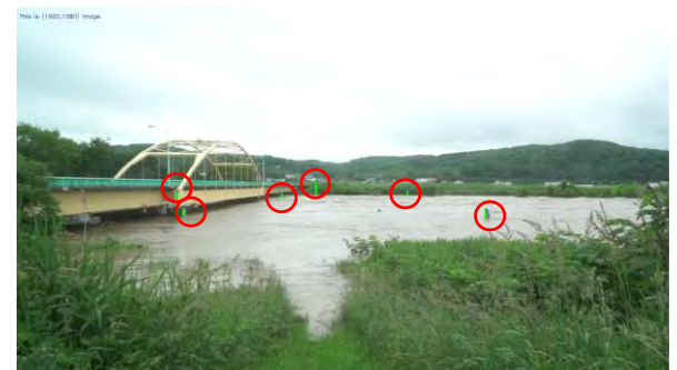
図-6 地上カメラによる標定点
