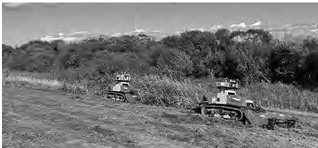
堤防除草の自動化実証試験
