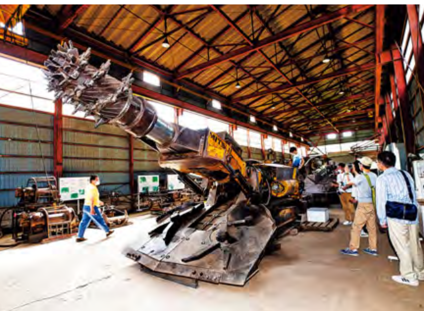
ロードヘッダー。先端部分が回転して坑道を掘削していく。これも日本製
