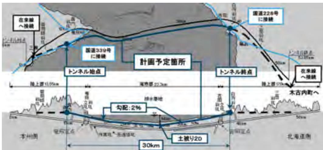
図3 津軽海峡トンネル平面図・縦断面図
