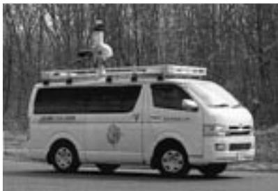
また、このシステムを車に搭載して40 km/hで走行しながら計測する試験をしたところ、実際に計測したケースと比較してみても誤差が数センチから数ミリ単位という検証結果がでています。従来の計測方法の固定点から測るという概念を変え、移動しながらの計測となりますが、計測精度としては驚異的で、このシステムの能力の高さが証明されるとともに、効率的で大幅なコスト縮減につながります。
