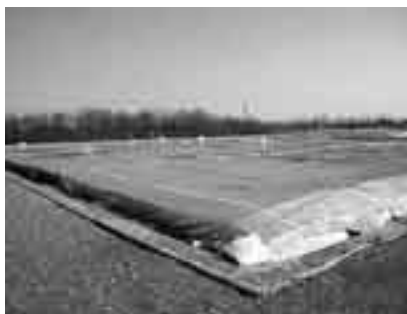
断熱・保管状況（雪1.5m+断熱材+遮光シート）
