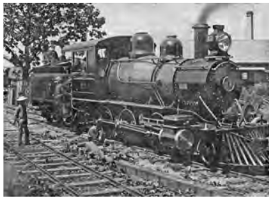
写真5 狩勝峠など急勾配を上るため北炭が1902（明治35）年に導入したアメリカ製機関車（国鉄では7350形）＝札幌市・川村雪江氏所蔵
