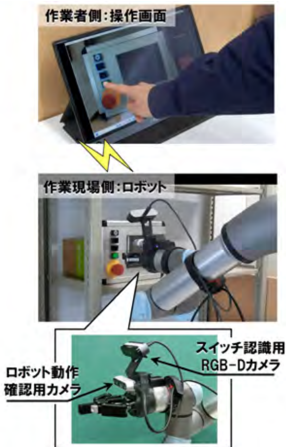
写真-5 遠隔制御盤操作ロボット
