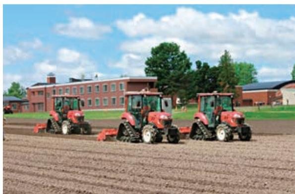
写真－3 ロボットトラクター複数台協調作業実演
