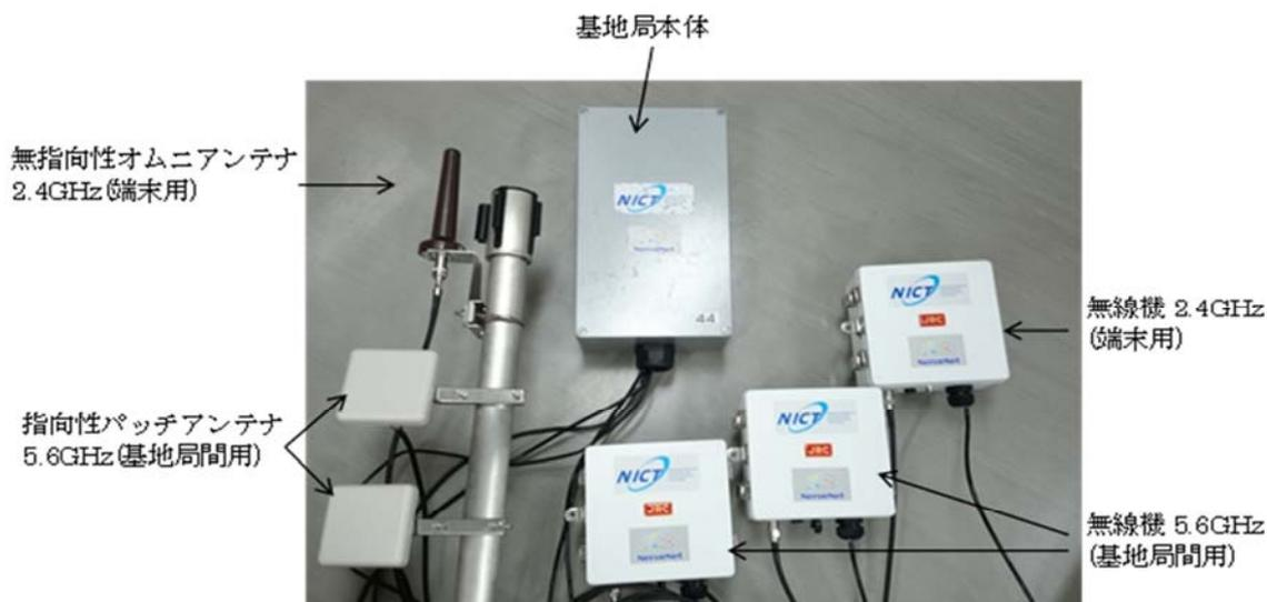
図12 基地局の機器構成
