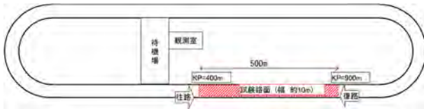
図-2 苫小牧寒地試験道路の試験区間概要図
