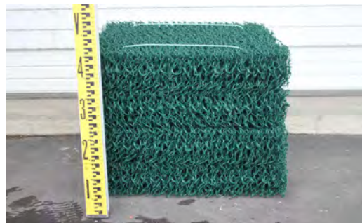
写真-5 ポーラスメディアによるマナマコ種苗捕捉施設
