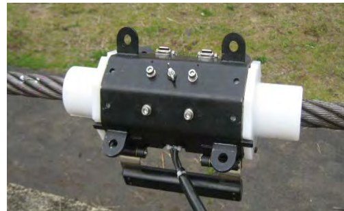
写真-5 ロープテスターによる断線調査
