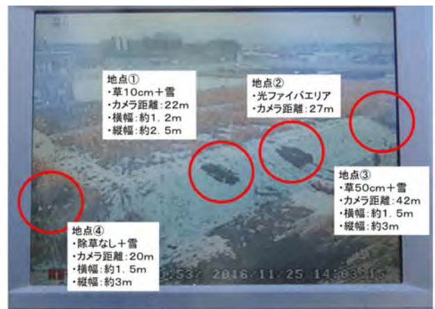
写真-5 変状を付与した箇所状況
