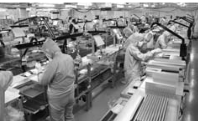
埼玉工場の針の組立製造はクリーンルームで行われている
