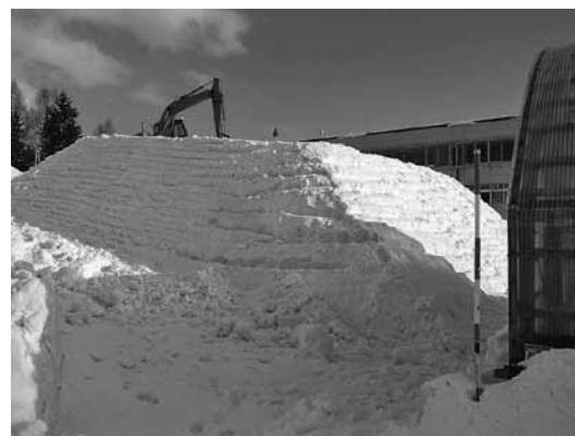
ニセコ高校で行われた雪氷熱の実験。堆積した雪山をバーク材で覆った
