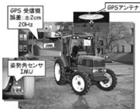
図2 車輪ロボットトラクタと航法センサ
