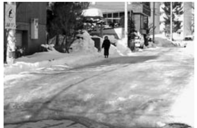
冬の生活道路は雪山で歩行空間が狭まり、車道を歩かざるを得ない場合が多い。車道にはつるつる路面が形成され、ロードヒーティングとの境目には段差ができてしまい危険である。
