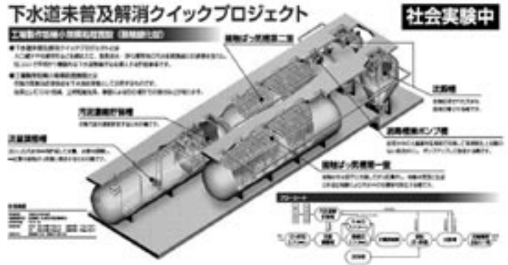
苫前町におけるクイックプロジェクト社会実験 (接触酸化型小規模施設による汚水処理)
