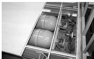
荷を積むターレットの後部には天然ガスボンベが載せられている
